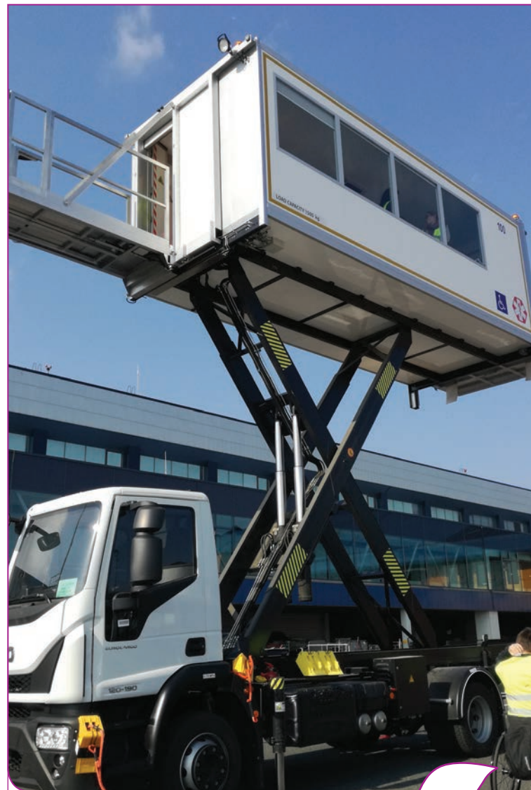
Tõstetav putka, mille abil tõusta lennuki ukseni.
